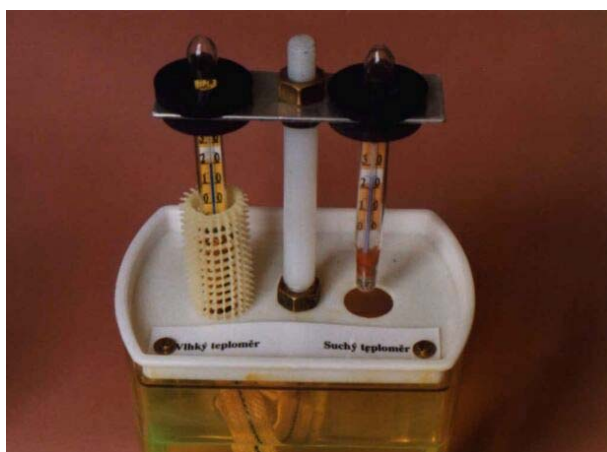
Obr. 5 Detail horní části stacionerního psychrometru. Vlevo je vlhký teploměr. Knot je nad víkem dózy pro zlepšení vzhledu přístroje kryt mřížkou.
