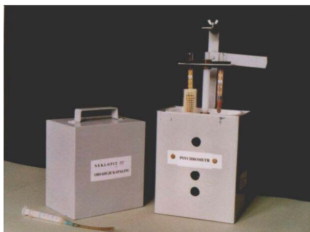
Obr. 2 Celkový pohled na otevřený stacionerní psychrometr. Vlevo horní kryt, vpravo vlastní přístroj v plechovém krytu při měření.
