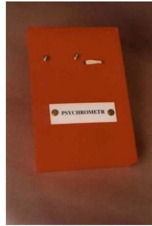
Obr. 8 Zavřený kazetový psychrometr. Před zavřením kazetového psychrometru je vhodné vylít vodu z nádoby. Jinak při položení kazety do vodorovné polohy voda vyteče.
